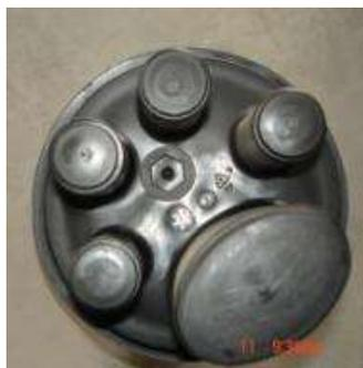
Cierre de empalme para conectar y derivar hasta 96 hilos de fibra óptica. Pre configurable en factoría a la densidad requerida (por ejemplo 48 fibras o 2 bandejas de empalme únicamente). Uso aéreo, en ductos o manholes indistintamente. Alta resistencia de los materiales al envejecimiento y cuerpo de alta resistencia mecánica. Todos los accesorios metálicos están fabricados en acero inoxidable para asegurar un largo tiempo en servicio. Incluye accesorios de fijación a muro o poste.
