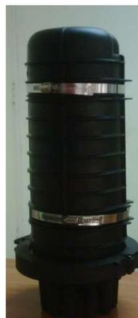
Cierre de empalme para conectar y derivar hasta 96 hilos de fibra óptica. Pre configurable en factoría a la densidad requerida (por ejemplo 48 fibras o 2 bandejas de empalme únicamente). Uso aéreo, en ductos o manholes indistintamente. Alta resistencia de los materiales al envejecimiento y cuerpo de alta resistencia mecánica. Todos los accesorios metálicos están fabricados en acero inoxidable para asegurar un largo tiempo en servicio. Incluye accesorios de fijación a muro o poste.
