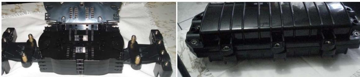
Cierre de empalme para conectar y derivar hasta 144 hilos de fibra óptica. Pre configurable en factoría a la densidad requerida (por ejemplo 96 fibras o 4 bandejas de empalme únicamente). Uso aéreo, en ductos o manholes indistintamente. Alta resistencia de los materiales al envejecimiento y cuerpo de alta resistencia mecánica. Todos los accesorios metálicos están fabricados en acero inoxidable para asegurar un largo tiempo en servicio.
