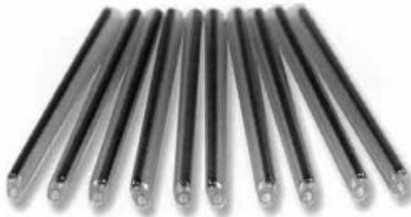
Estas fundas de protección de los empalmes de fusión de fibra única están disponibles en múltiples longitudes. Los manguitos consisten en un tubo termo encogible exterior, un tubo interno fundible y una varilla de acero inoxidable 201 para proteger el radio de curvatura y añadir rigidez al empalme.
