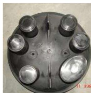
Cierre de empalme para conectar y derivar hasta 576 hilos de fibra óptica. Pre configurable en factoría a la densidad requerida (por ejemplo 144 fibras o 2 bandejas de empalme únicamente). Uso aéreo, en ductos o manholes indistintamente. Alta resistencia de los materiales al envejecimiento y cuerpo de alta resistencia mecánica. Todos los accesorios metálicos están fabricados en acero inoxidable para asegurar un largo tiempo en servicio. Incluye accesorios de fijación a muro o poste.
